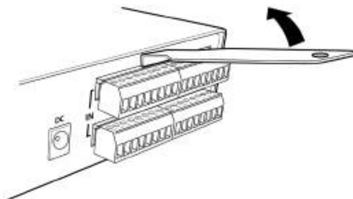
コネクタ着脱工具を図のようにコネクタの間の溝に差し込み、コネクタ着脱工具を左右に振り溝を徐々に広げていきはずします。
